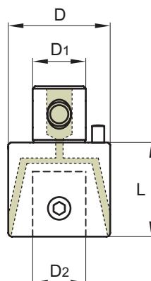
**ПРИМЕЧАНИЕ:** ПРИ ЗАКАЗЕ ОПРАВОК ДЛЯ ИСПОЛЬЗОВАНИЯ СОВМЕСТНО С УДЛИНИТЕЛЯМИ, ИМЕЮЩИМИ КАНАЛЫ ДЛЯ ПОДАЧИ СОЖ В ЗОНУ РЕЗАНИЯ, К ОБОЗНАЧЕНИЮ ОПРАВКИ НЕОБХОДИМО ДОБАВЛЯТЬ БУКВУ «R», НАПРИМЕР:
