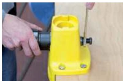
Приспособление крепится к верстаку и обеспечивает надежную фиксацию цанговых патронов, оправок для расточного инструмента, оправок для насадных фрез и патронов для инструмента с хвостовиком Weldon, позволяя легко устанавливать и извлекать инструмент и штревель.
