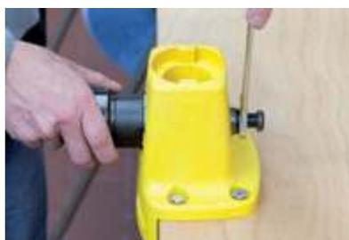
Приспособление крепится к верстаку и обеспечивает надежную фиксацию цанговых патронов, оправок для расточного инструмента, оправок для насадных фрез и патронов для инструмента с хвостовиком Weldon, позволяя легко устанавливать и извлекать инструмент и штрель.
