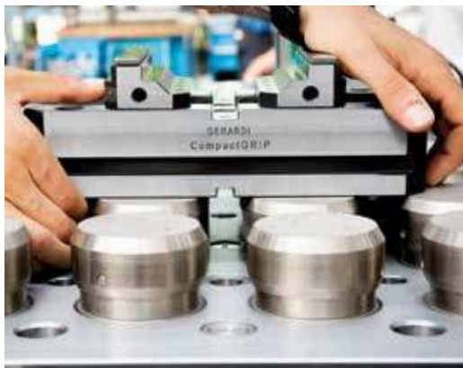
Ampia zona di ancoraggio flessibile in funzione alla morfologia dei particolari Wide flexible clamping area according to the workpiece to be clamped
