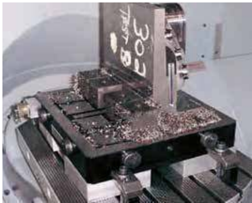
Espansioni polari - Chuck shoes
