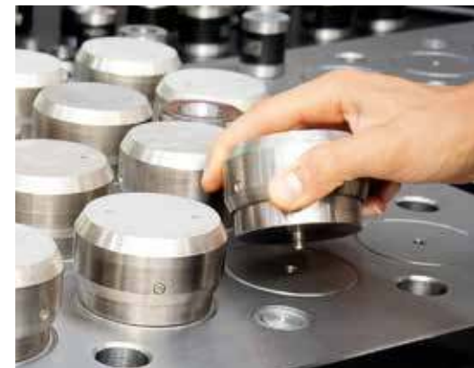
Espansioni polari mobili - Mobile pole chucks
