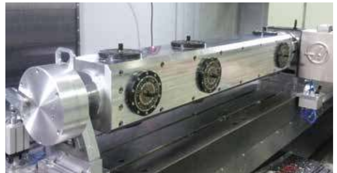
Attrezzatura speciale con Zero Point applicata su tavola girevole HAAS Special aluminum Zero Point fixture on HAAS rotary table
