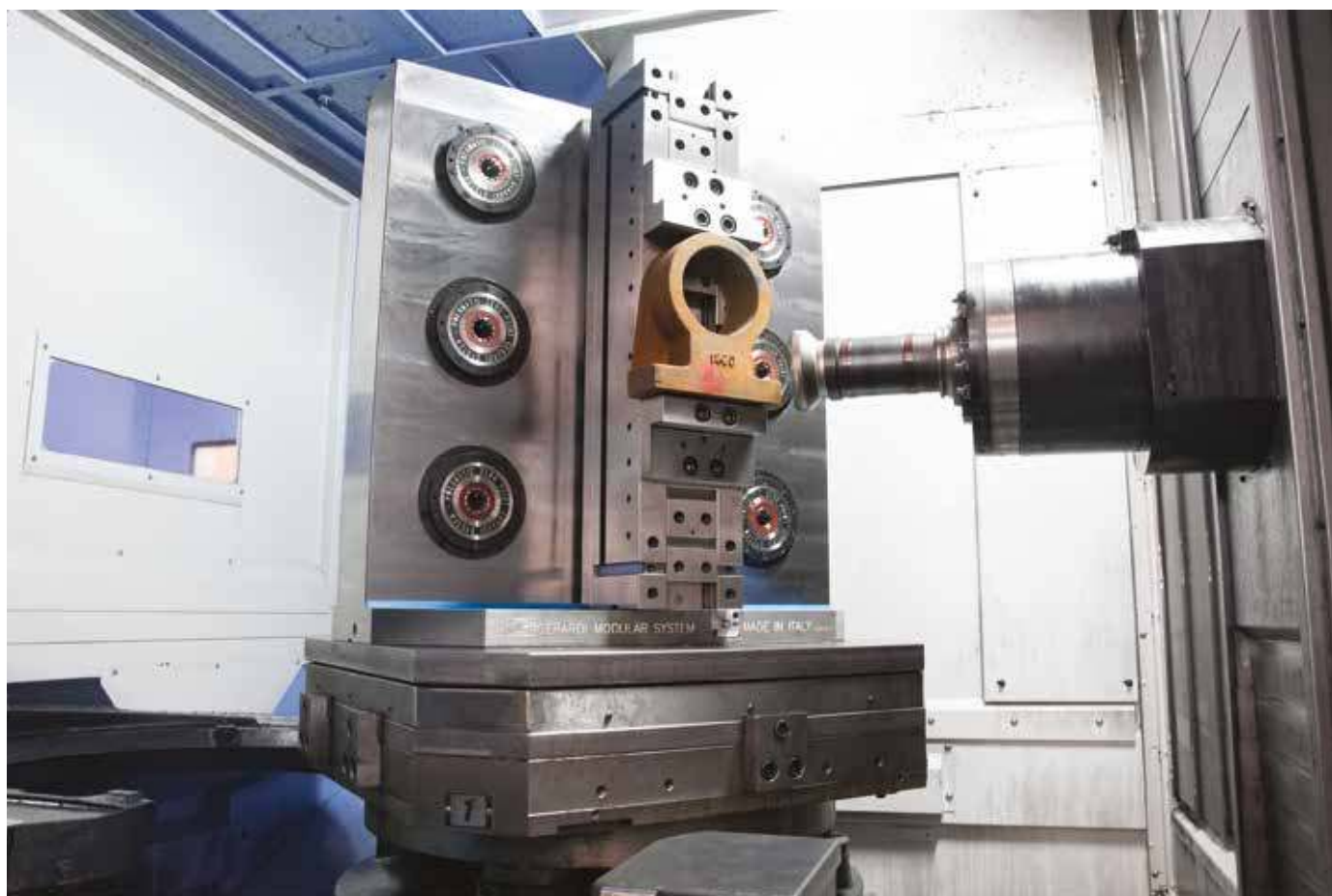
Spalla porta-pezzo in fusione monoblocco con n°18 unità ZERO POINT Art.665 tipo 2 con morsa FMS autocentrante Art.863 tipo 5x800 Tombstones in solid cast iron with n°18 Zero point units Art.665 type 2 with FMS vise chuck Art.863 type 5x800
