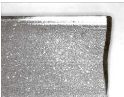
Износ на верхней части полотна
