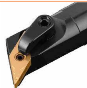
Державка MVQNR/L. Угол в плане 117°5'
