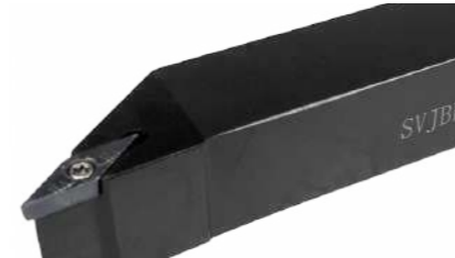
Державка SVJBR/L. Угол в плане 93°
