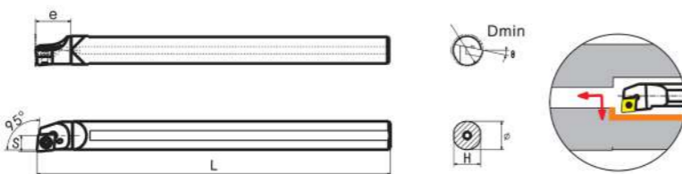
Державка SCLCR/L. Угол в плане 95°
