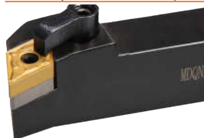
Державка MDQNR/L. Угол в плане 107°30'
