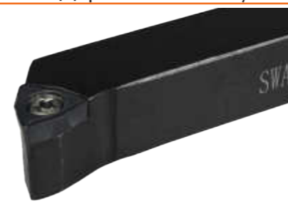
Державка SWACR/L. Угол в плане 90°
