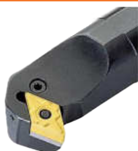
Державка PDSNR/L. Угол в плане 62°30'
