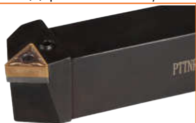
Державка PTTNR/L. Угол в плане 60°
