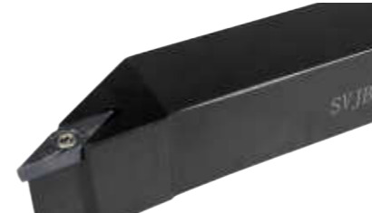
Державка SVJBR/L. Угол в плане 93°
