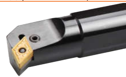
Державка PDUNR/L. Угол в плане 93°
