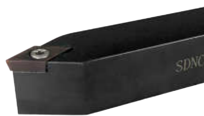
Державка SDNCN. Угол в плане 62°30'
