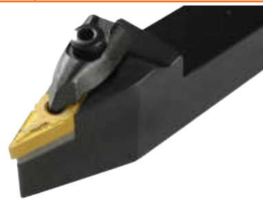
Державка DVVNN. Угол в плане 72.5°
