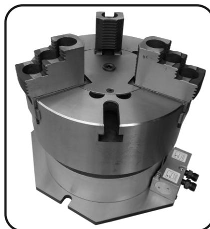
Приспособления пневматические зажимные предназначены для выполнения работ на станках сверлильно-фрезерной группы. Представляют собой токарный клиновой механизированный патрон, закрепленный на гильзе пневмоцилиндра через переходной фланец. Перемещение тяги штока патрона производится посредством подачи сжатого воздуха в полости пневмоцилиндра через коллектор. В коллектор встроен пневмозамок, обеспечивающий поддержание силы зажима детали (заготовки) в патроне.
