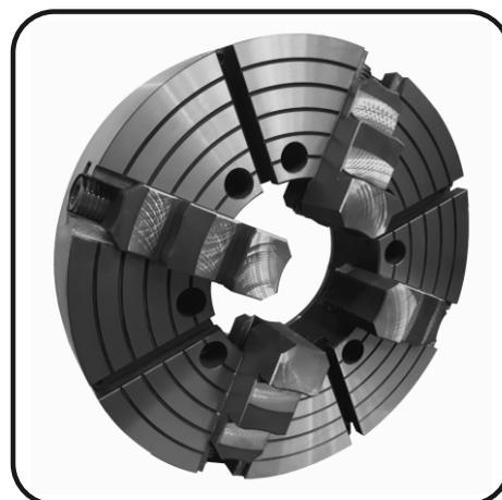
Патроны предназначены для зажима и обработки труб, пруткового материала и штучных заготовок сложной конфигурации, несимметричных, эксцентриковых (отливки, поковки и т.п.) на станках токарной группы.
