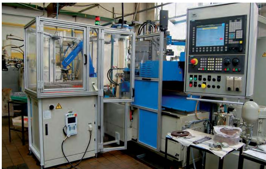
Шлифовка стружечных канавок
