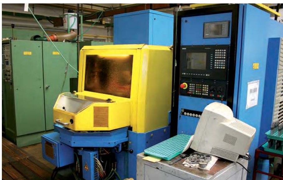
Шлифовка стружечных канавок
