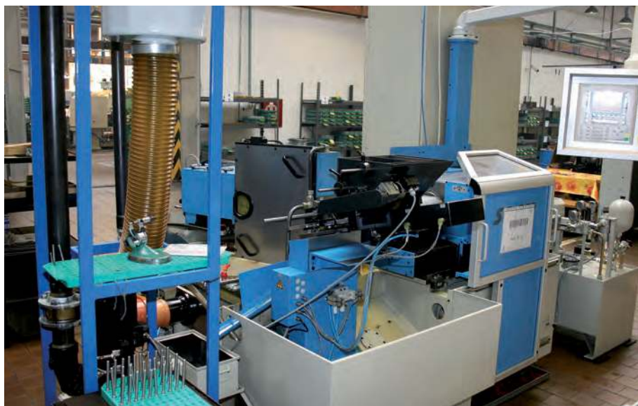
Шлифовка квадрата хвостовика
