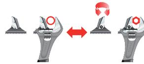
Переставив съемную губку, этот ключ можно использовать в качестве стандартного разводного ключа для гаек и болтов.
